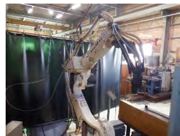
溶接ロボット
