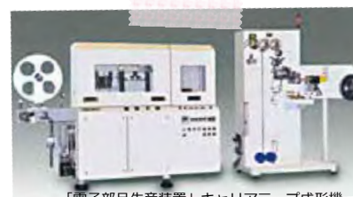
「電子部品生産装置」キャリアテープ成形機
